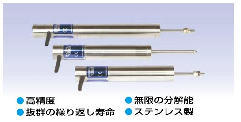
ACTシリーズは変位・ポジションを高精度に測定するために定評のあるLVDT方式 (差動トランス)を採用した長ストローク変位計です。LVDT方式の変位計は本体(差動トランス部)と接触子(アーマチュア)で構成されており、この2つのパートは電気的な接触がないので長期間に渡りノイズの少ないクリーンな変位・ポジションデ ータを無限の分解能で検出することができます。
